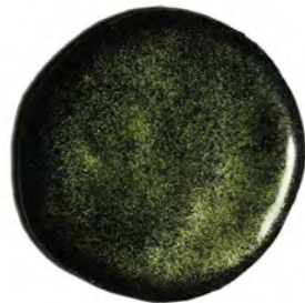
(d) 90 sec at 810 °C — Over firing.
